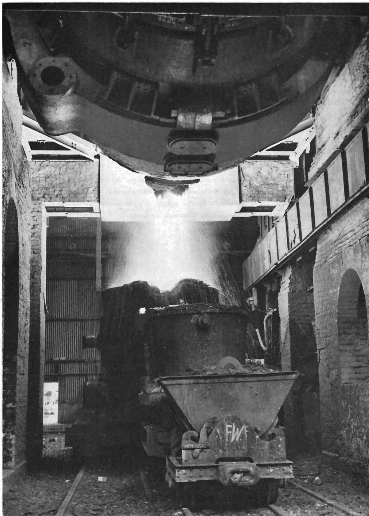
Abgießen des Blasstahles aus dem LD-Tiegel Tapping of LD-steel from a vessel Coulée de l'acier L. D. d'un convertisseur
