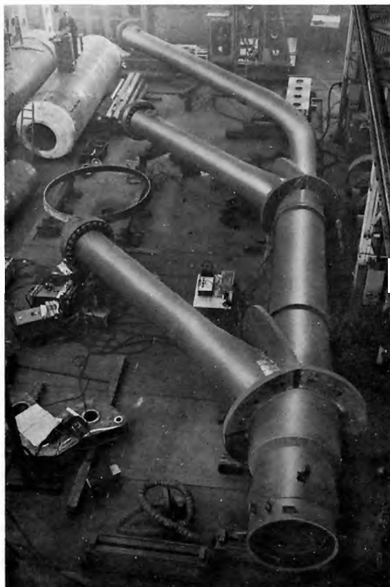
Bild 47: Verteilrohrleitung der Zentrale Riddes (Anlage Mauvoisin, Walliser Alpen), Teilstück mit den drei letzten Turbinenabzweigen, mit Deckeln verschlossen, als „Behälter“ abgepreßt, Prüfdruck gleich dem 1,33-fachen größten Betriebsdruck. Durchführung von Dehnungsmessungen im Bereich der Sulzerkragen. Werk Winterthur der Gebrüder Sulzer AG, Winterthur
