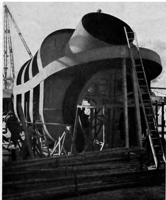
Bild 15: Hosenrohr für den gepanzerten Druckschacht des Innkraftwerkes Prutz-Imsst der TIWAG. \varnothing 4400/3500/2400 mm, ALDUR-Stahl 47, Wandstärke 20 mm. Waagner-Biró AG, Wien-Graz
