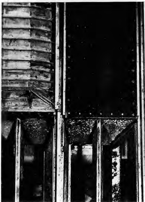
Metall-modell zur Unter-suchung der Sog-wirkung auf die 8,6 × 14 m Not-verschluß-schütze vor den Turbinen-einläufen des Kraft-werkes Assuan
