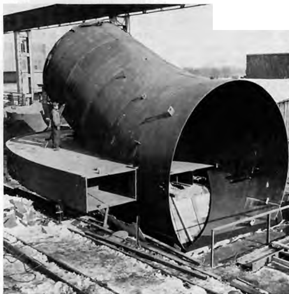
Bild 4: Hosenrohr 5940/2 X 4200 mm Durchmesser für das Kraftwerk Sariyar im Werkszusammenbau
